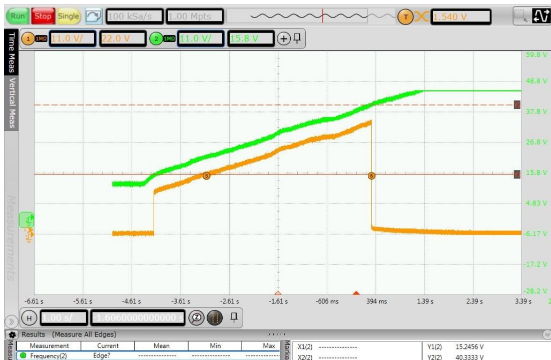
Abbildung 6.1: Verifizierter Über- sowie Unterspannungsschutz am TPS26601
