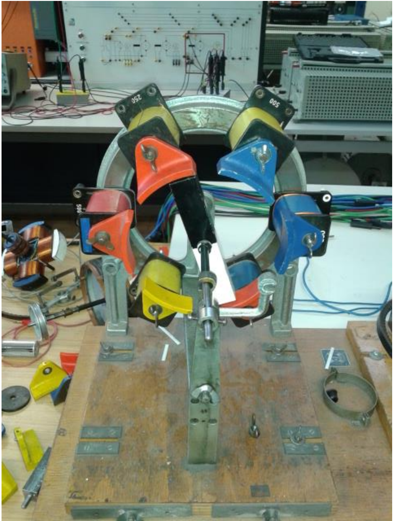
Abbildung 22: Synchrongenerator Aufbau mit Motorbaukasten
