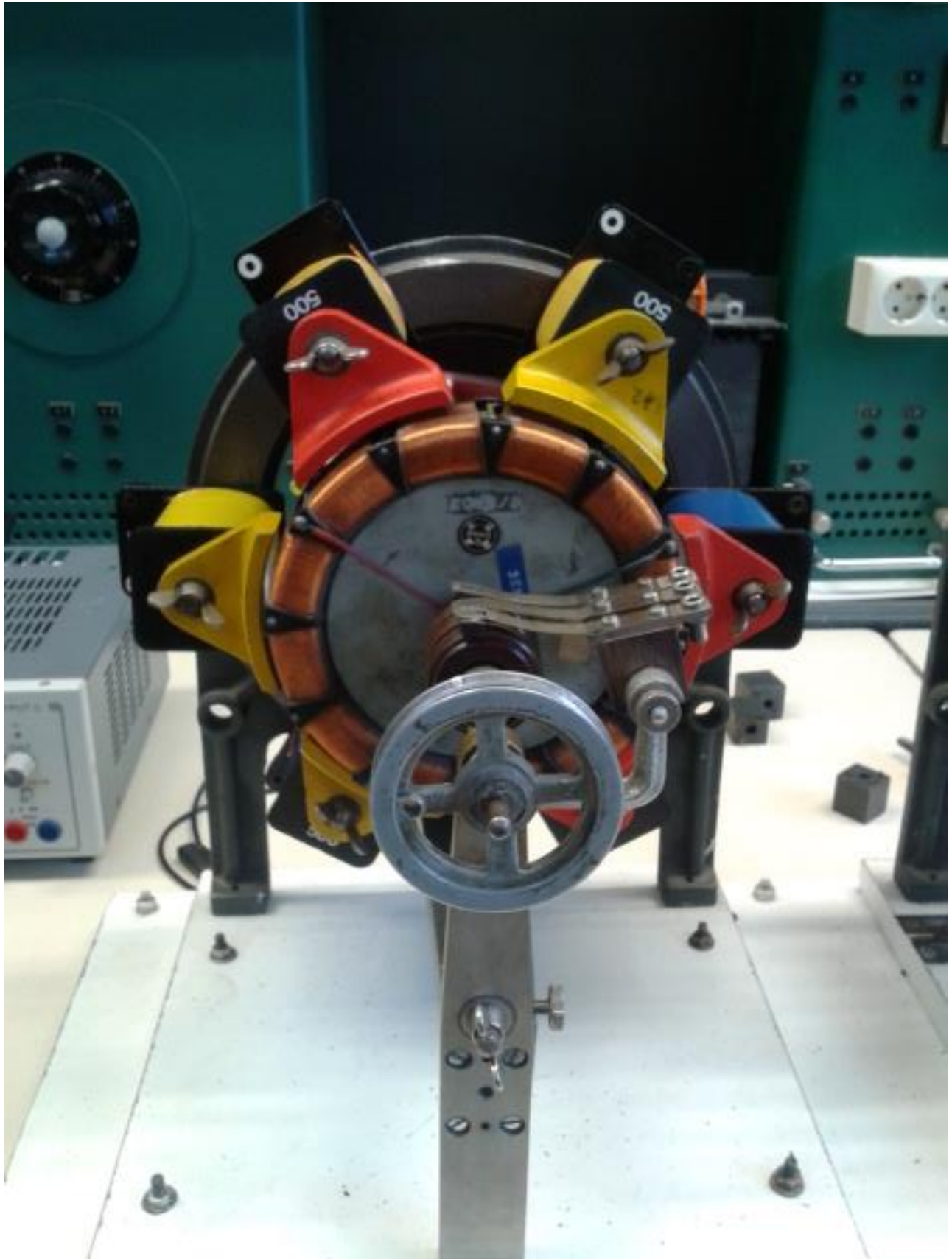
Abbildung 17:Aufbau Induktionsmaschine mit Motorbaukasten
